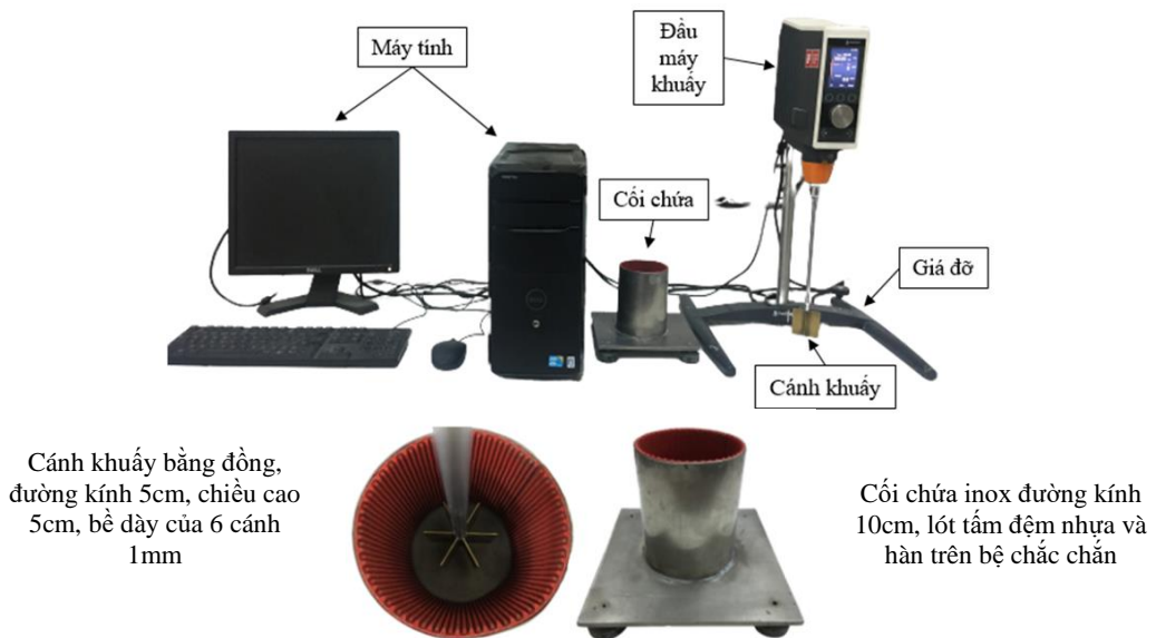
Hình 4. Cấu tạo hệ thống lưu biến kế quay đồng trục dạng cánh
