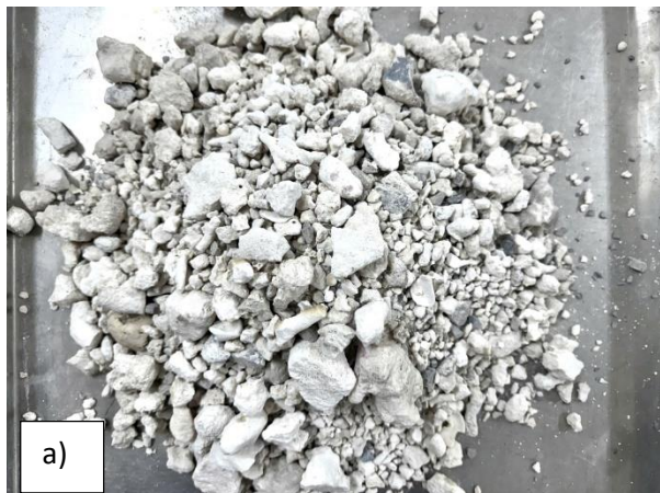
Hình 1. Mẫu cát san hô; a) Thành phần cốt liệu lớn hơn 5mm; b) Thành phần cốt liệu nhỏ hơn 5mm
