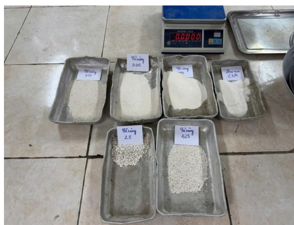
Hình 3. Thí nghiệm xác định thành phần hạt của cát san hô (đã loại bỏ hạt kích cỡ lớn hơn 5mm)
