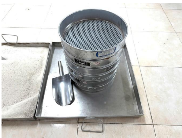
Hình 3. Thí nghiệm xác định thành phần hạt của cát san hô (đã loại bỏ hạt kích cỡ lớn hơn 5mm)
