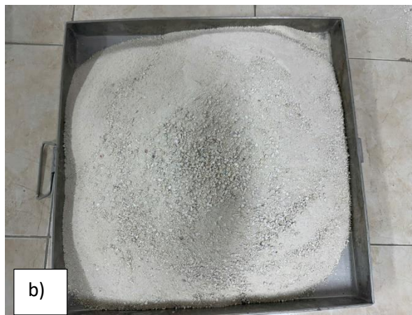
Hình 1. Mẫu cát san hô; a) Thành phần cốt liệu lớn hơn 5mm; b) Thành phần cốt liệu nhỏ hơn 5mm
