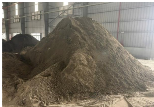
Hình 7. Mẫu vật liệu san lấp lần biển từ phế thải thạch cao
