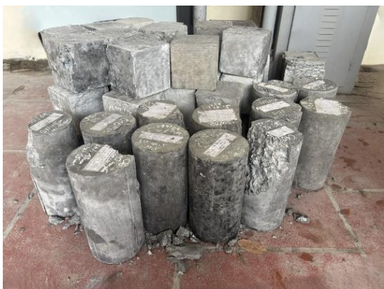
Hình 12. Thí nghiệm xác định cường độ nén của mẫu thí nghiệm
