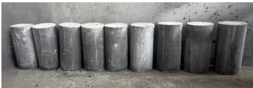
Hình 11. Mẫu bê tông hình trụ đường kính D = 150 mm và chiều cao H = 300 mm
