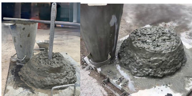
Hình 10. Xác định độ sụt của hỗn hợp bê tông ngay sau khi nhào trộn
