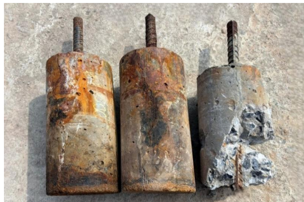
Hình 9. Bề mặt các mẫu thí nghiệm bị phá hoại theo phương pháp ăn mòn nhanh
