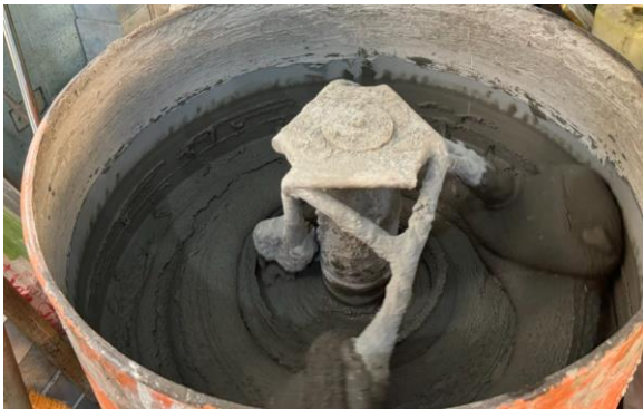
Hình 2. Hỗn hợp UHPC sau khi đạt được độ dẻo phù hợp
