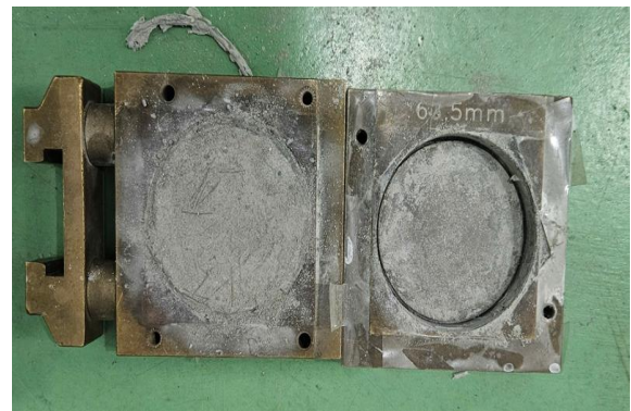
Hình 6. Minh họa dạng phá hoại sau thí nghiệm cắt
