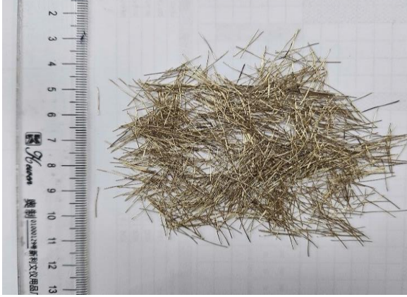
Hình 1. Sợi thép trong hỗn hợp UHPC
