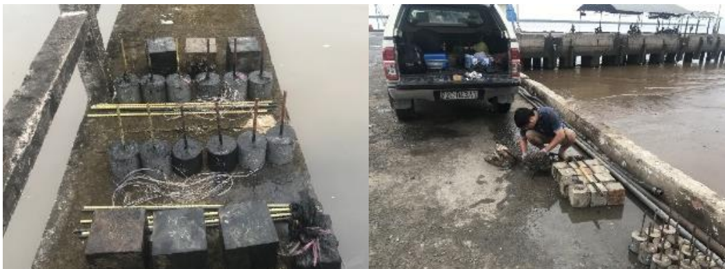
Hình 3. Bảo dưỡng các mẫu thử tại Bình Đại, Bến Tre
