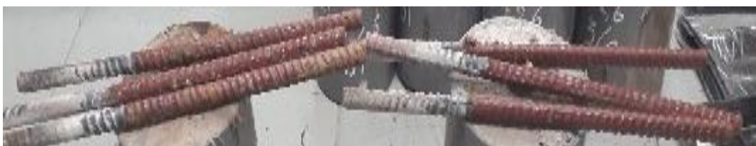
Hình 5. Mẫu thử độ bám dính cốt thép sau khi thử
