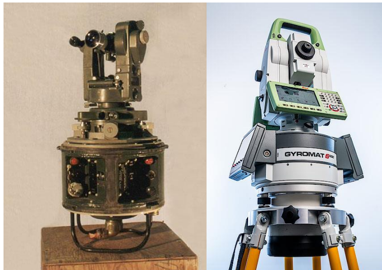
Hình 6. Kinh vĩ con quay và toàn đạc điện tử con quay (Nguồn: Internet)
