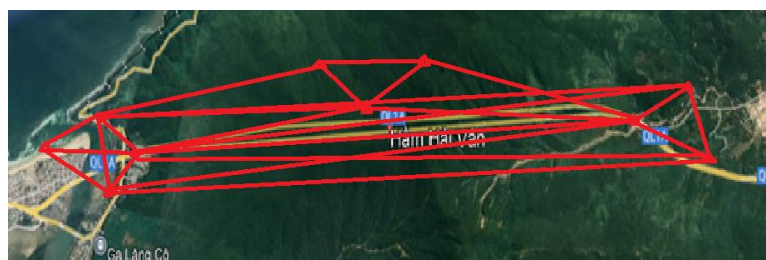
Hình 2. Lưới trên mặt đất đo bằng công nghệ GNSS
