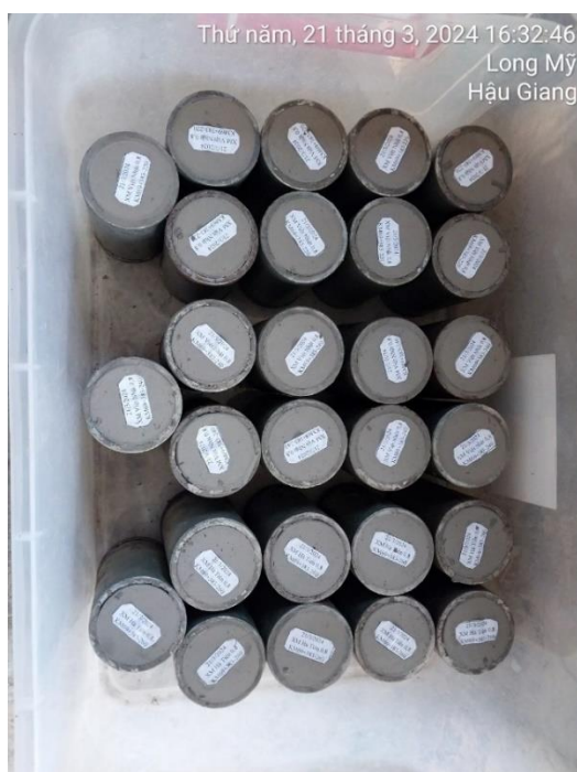
Hình 1. Mẫu xi măng đất sau khi chế tạo theo TCVN 9906:2014 và thí nghiệm nén mẫu theo ASTM D1633-00(07) kết hợp ASTM D2166-16
