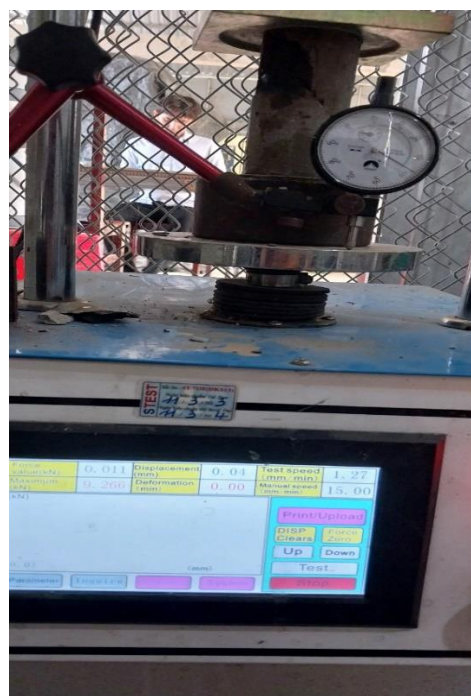
Hình 1. Mẫu xi măng đất sau khi chế tạo theo TCVN 9906:2014 và thí nghiệm nén mẫu theo ASTM D1633-00(07) kết hợp ASTM D2166-16
