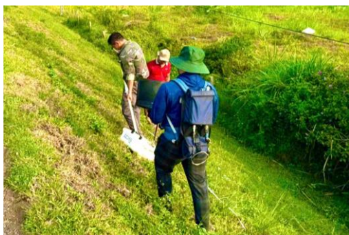
Hình 9. Khảo sát radar xuyên đất tại hiện trường
