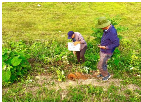
Hình 11. Khoan khảo sát khoang rỗng
