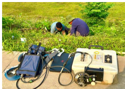
Hình 9. Khảo sát radar xuyên đất tại hiện trường
