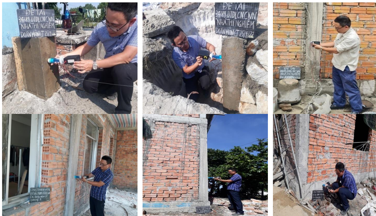
Hình 8. Kiểm tra bằng phương pháp đo hiệu điện thế
