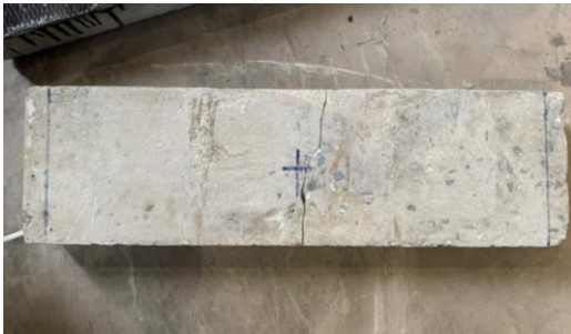
a. Tấm BTCT không gia cường (nứt mặt trên)
