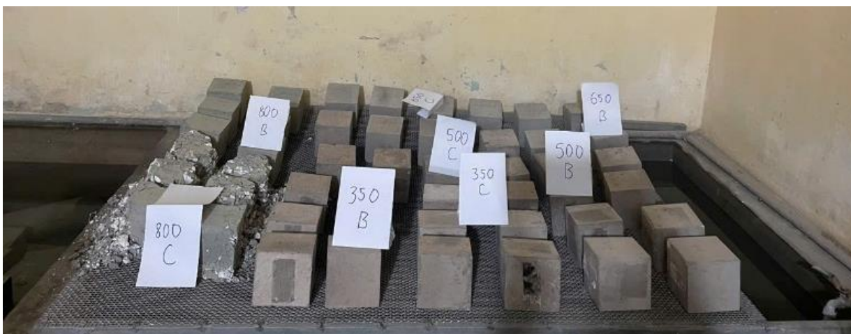
Hình 1. Mẫu bê tông ở các điều kiện nhiệt độ khác nhau trong quá trình bảo dưỡng
