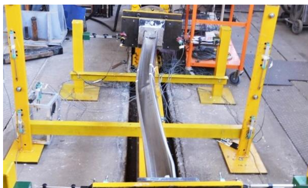
Hình 2. Dạng mất ổn định tổng thể uốn-xoắn khi chịu nén
