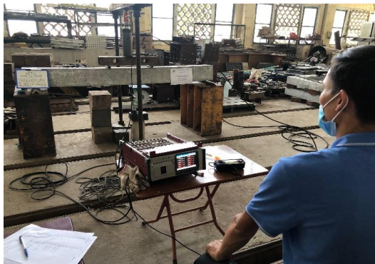
Hình 2. Sơ đồ bố trí dụng cụ đo và quá trình thử nghiệm
