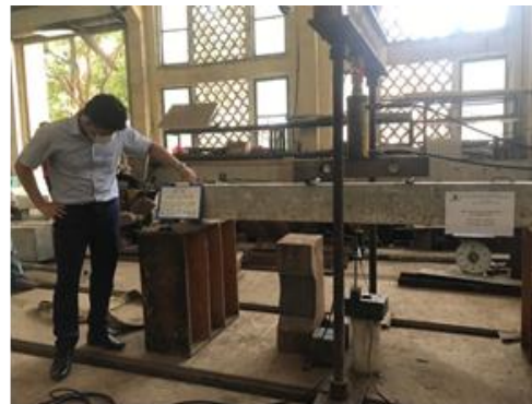
Hình 2. Sơ đồ bố trí dụng cụ đo và quá trình thử nghiệm
