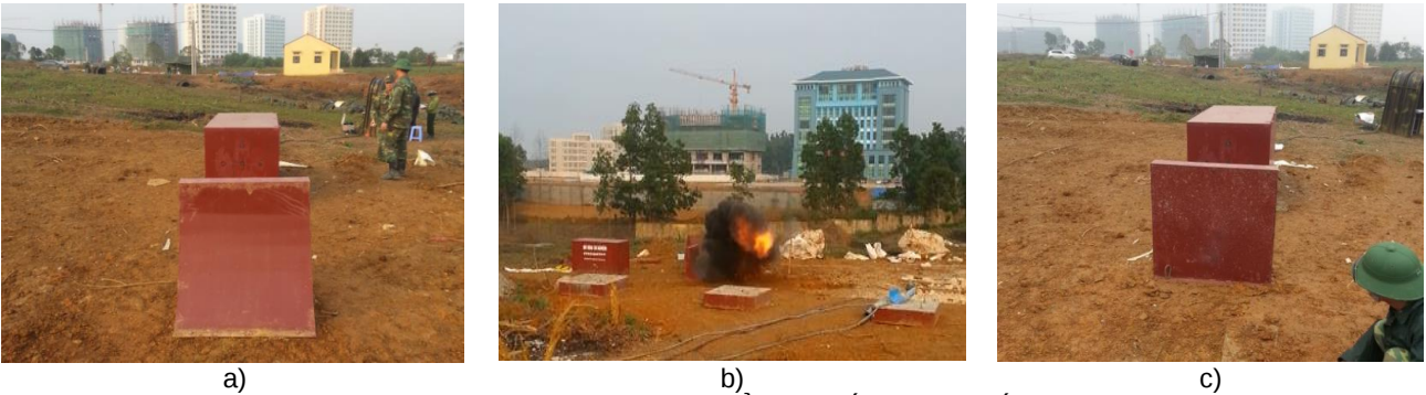
Hình 8. Hình ảnh thí nghiệm nổ khi có bố trí tường chắn. a) Tường chắn dạng hình thang; b) Tường chắn dạng tường kê chắn sóng mặt cong hướng về lượng nổ; c) Tường chắn dạng hình chữ nhật
