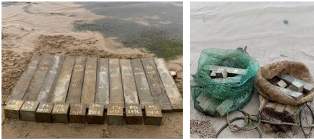
Hình 3b. Bảo dưỡng mẫu bằng nước biển
