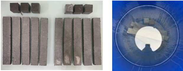
Hình 3a. Bảo dưỡng mẫu bằng nước thường
