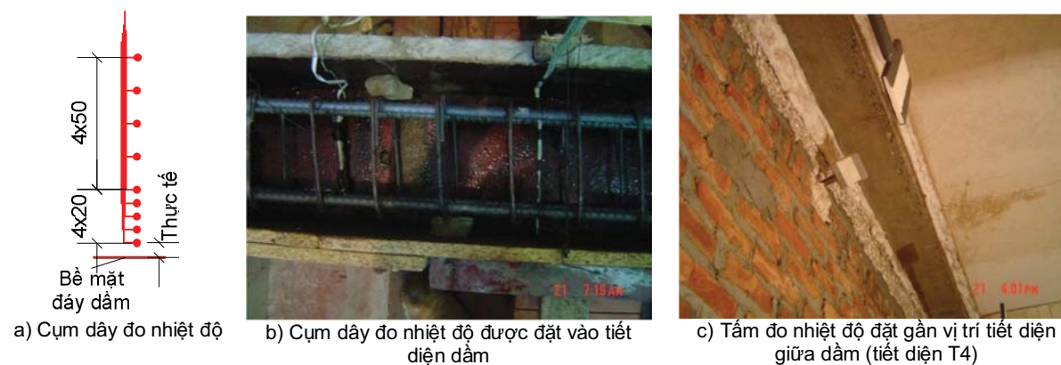
Hình 1. Cấu tạo và bố trí lắp đặt đầu đo nhiệt độ trên mẫu
