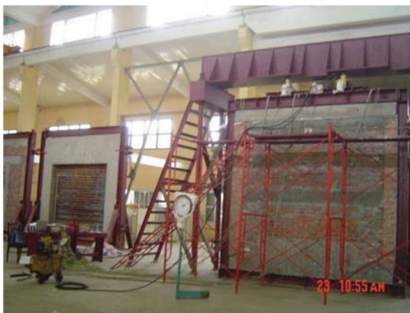
Hình 2. Quá trình thử nghiệm trên lò đốt theo phương đứng và hệ gia tải kèm theo
