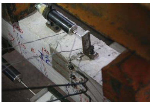
Hình 10. Bê tông vùng nén bị phá vỡ
