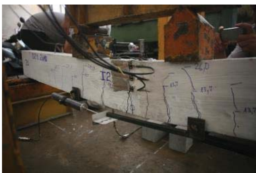
Hình 9. Sự phát triển vết nứt dầm D2.1
