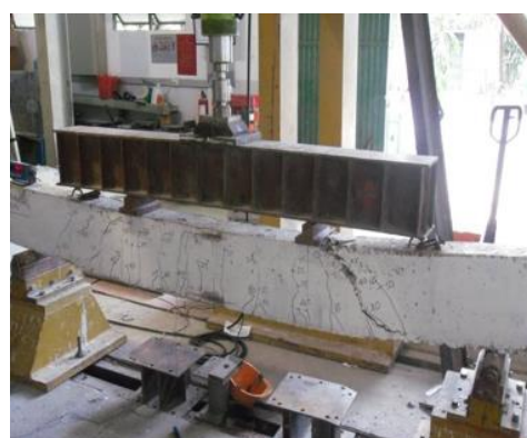
Hình 9. Uốn kết hợp với cắt (dầm D 2 )
