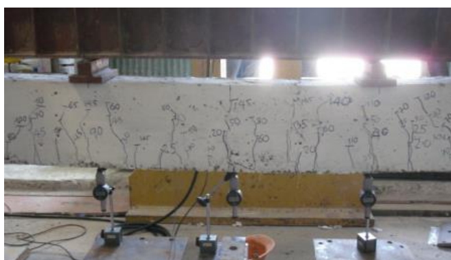
Hình 8. Uốn kết hợp với bê tông phá vỡ vùng nén (dầm D 1 )
