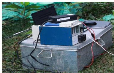
Hình 1. Bố trí thí nghiệm đo áp lực nổ không khí hiện trường
