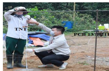
Hình 1. Bố trí thí nghiệm đo áp lực nổ không khí hiện trường
