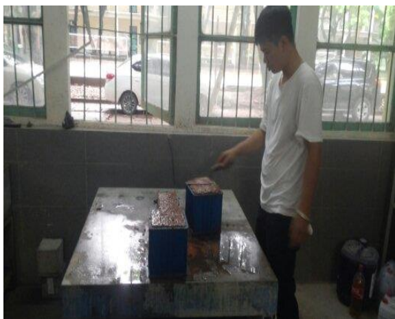
Hình 1. Chế tạo và nén kiểm tra cường độ mẫu bê tông
