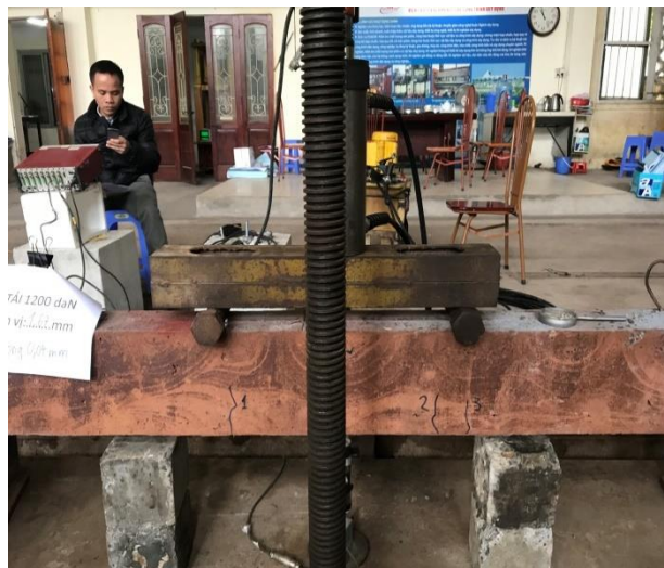
Các vết nứt xuất hiện khi tải tác dụng lên dầm 12kN
