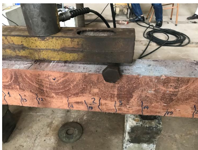
Vết nứt rộng 1mm tương ứng với lực P=40kN
