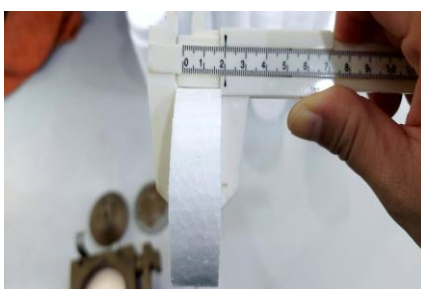
Hình 6. Đo kích thước và chuẩn bị thí nghiệm mẫu xốp EPS và XPS
