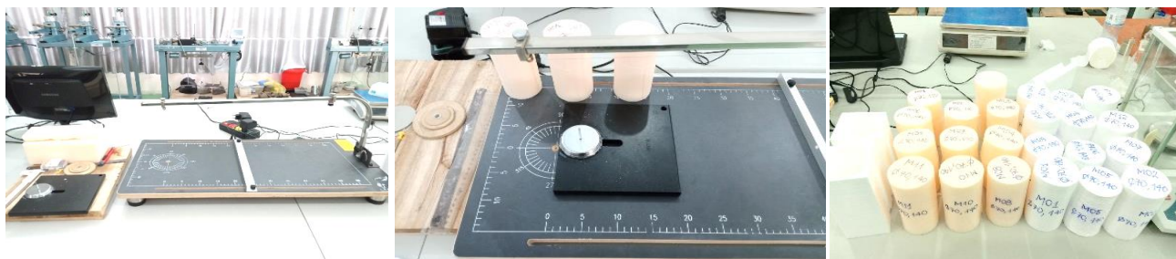
Hình 2. Thiết bị chế tạo mẫu EPS trong phòng thí nghiệm
