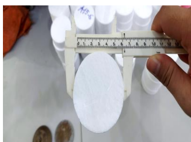
Hình 6. Đo kích thước và chuẩn bị thí nghiệm mẫu xốp EPS và XPS
