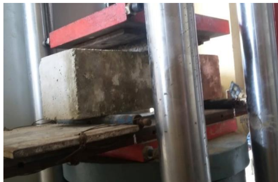
b) Thí nghiệm kéo uốn
